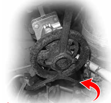
عجلة جزير مصنوعة من الحديد الصلب ومتآكلة لإظهار فائدة الفولاذ المقاوم للصدأ
